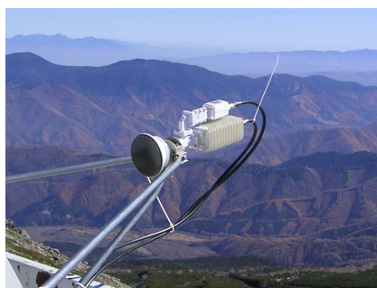
図 11: ODU:大きいユニット (下部) が送信・小さいユニット (上部) が受信を行う
