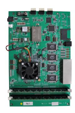
図 1: プログラマブル三層構造 FPGA ボードの試作機 (トランスニュー・テクノロジー社提供)
